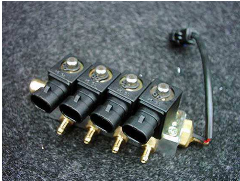
Injektorska opora pred montažo v vozilo.
