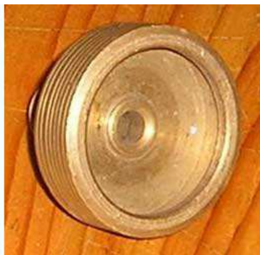
Adapter za polnilni ventil omogoča polnjenje rezervoarja s plinom v krajih z drugačnim nastavkom polnilne pištole.
