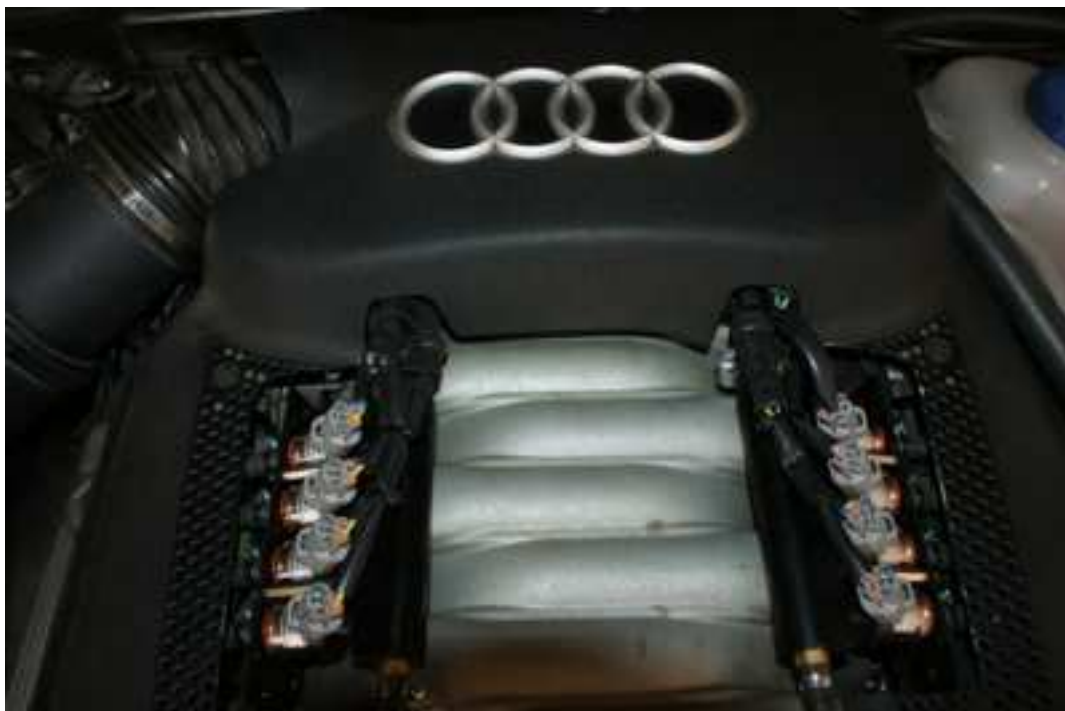
Plinski injektorji in injektorska opora po izvršeni montaži.
