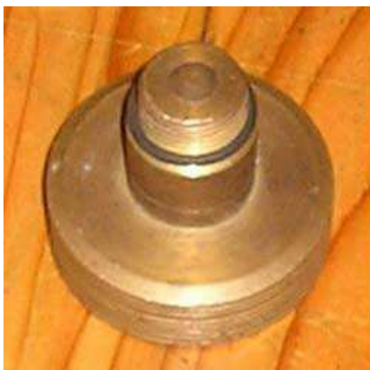
Adapter za polnilni ventil omogoča polnjenje rezervoarja s plinom v krajih z drugačnim nastavkom polnilne pištole.
