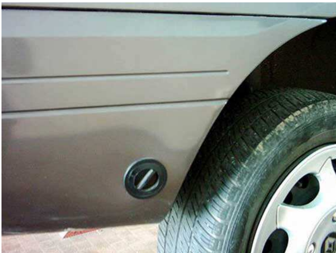
Zelo običajna postavitev polnilnega ventila.
